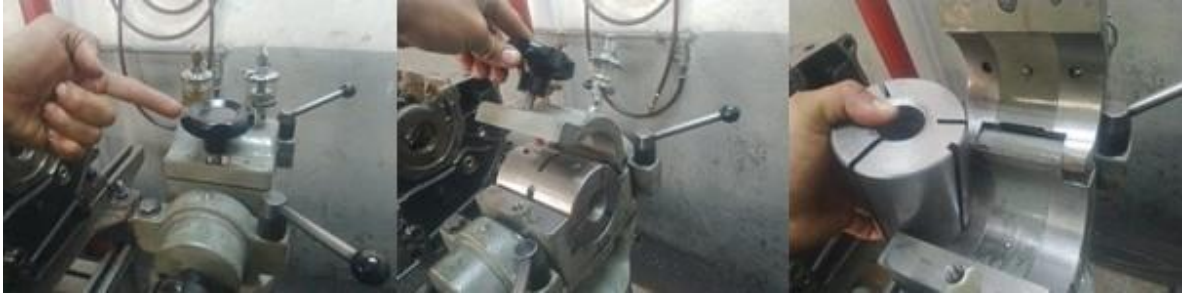
Figura 55. Pasos para cambiar cojinete de barra
