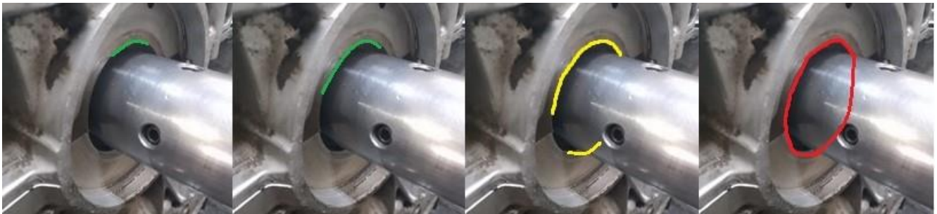
Figura 83. Escala de cortes en la bancada
