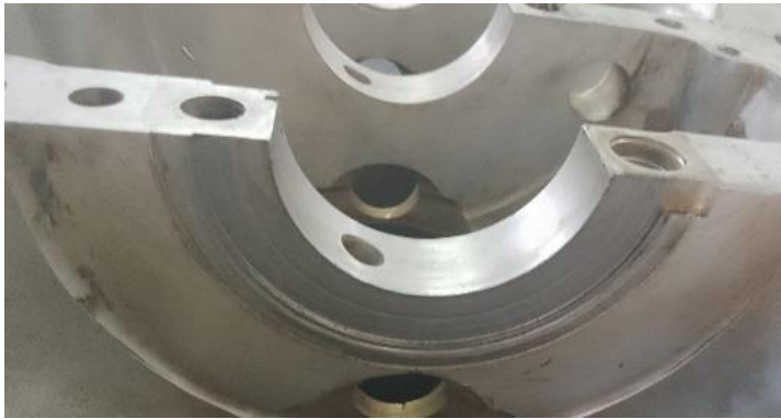
Figura 106. Desgaste del cajón axial de Urvan 2.5.
