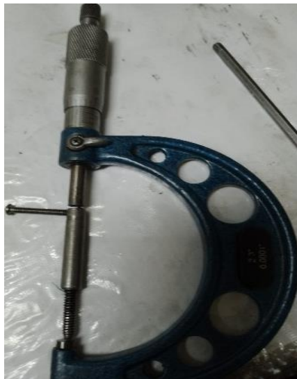
Figura 86. Micrómetros utilizados en el rectificado de bancada
