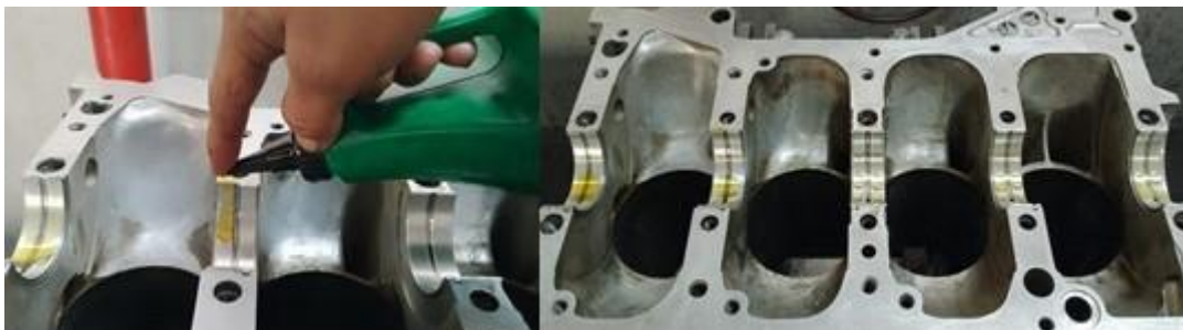
Figura 88. Proceso de armado de bancada
