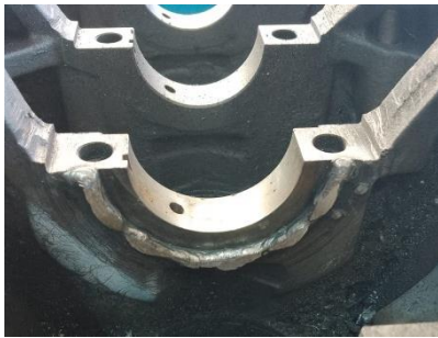
Figura 42. Cajón de Tsuru 1.6 rellenado
