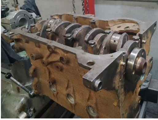
Figura 96. Monoblock de Jetta 1.8 terminado
