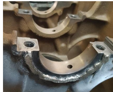
Figura 41. Cajón de Urvan 2.5 rellenado
