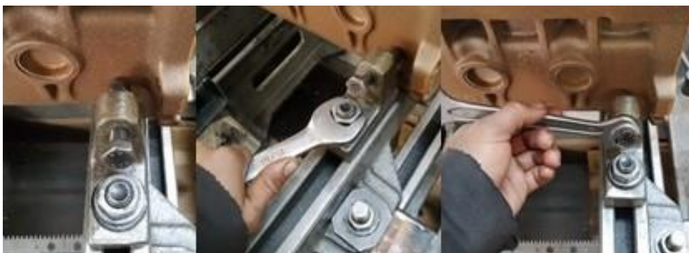
Figura 62. Pasos para ajustar puntillas
