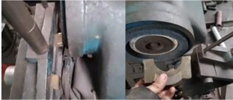
Figura 72. Proceso de desbaste para tapas de Tsuru 1.6 y Jetta 1.8
