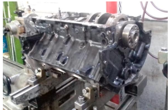
Figura 99. Motor V8 montado para corte en línea
