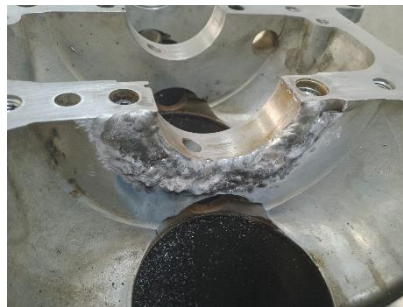
Figura 43. Cajón de Jetta 1.8 rellenado
