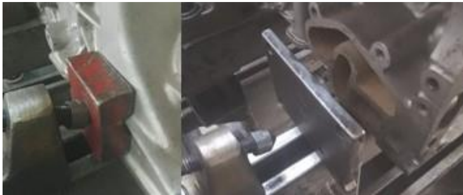
Figura 61. Placas para brindar estabilidad a las puntillas
